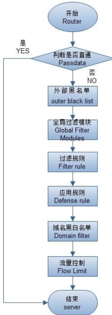
数据包进入清洗系统后，清洗系统会首先判断其访问服务器是否设置有直通规则。对于设置直通的服务器，清洗系统直接转发该服务器的入向与出向数据流，不做任何过滤。否则交由外部黑白名单模块处理。如果外部 IP 在黑名单中，清洗系统会拦截其数据流，其余部分流量接着向下转发。如有外部 IP 在白名单中，则直接将此 IP 发送的数据流交给本地服务器。全局过滤模块采用傲盾特有的数据流指纹识别技术对接收的数据包进行过滤，在这里，常见 DDOS 攻击数据将被识别和丢弃。通过全局过滤模块的数据包将被送入过滤规则进行过滤，过滤规则对数据包进行简单有效的过滤。对于放行的数据包则会转入应用规则模块过滤。域名插件主要用于协助管理员对本机房域名进行审查，所有本机房备案与未备案的域名是否能被外网访问，将会在这里得到控制。流量控制模块则会对最终流向服务器的数据流进行最终的流量限制，最后转发至服务器。
